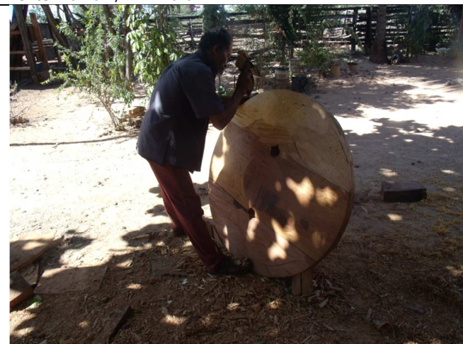
Figura 6: Acabamento na roda.
