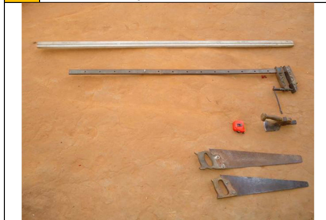
Figura 2: Algumas ferramentas utilizadas no processo de construção de barco: serrote, trena, enxó, sager, régua. Fonte: NUHICRE/IEPHA-2013.
