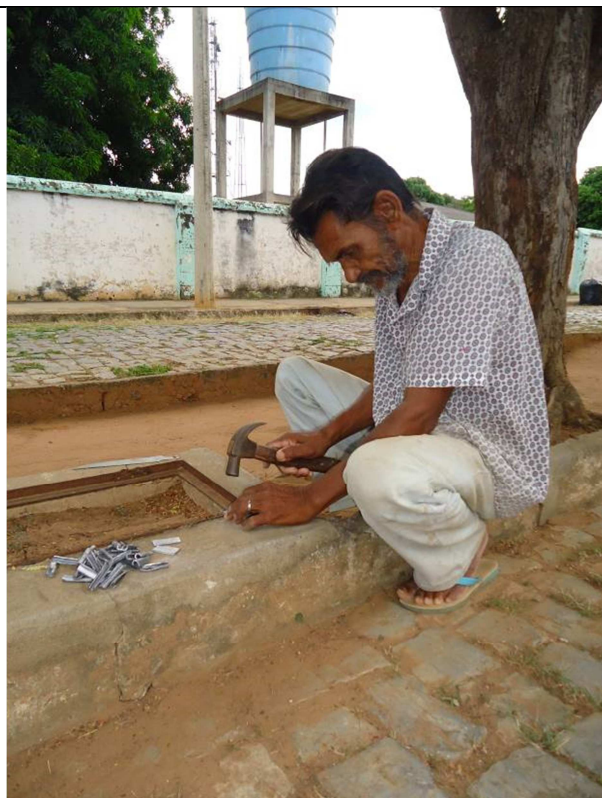
Figura 4: Artesão moldando o chumbo e transformando-o em chumbadas para acrescentar às redes de pesca. Fonte: NUHICRE/IEPHA-2013.
