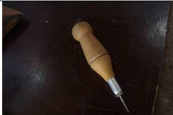
Figura 3: Sovela: ferramenta para furar o couro. Fonte: NUHICRE/IEPHA-2012.
