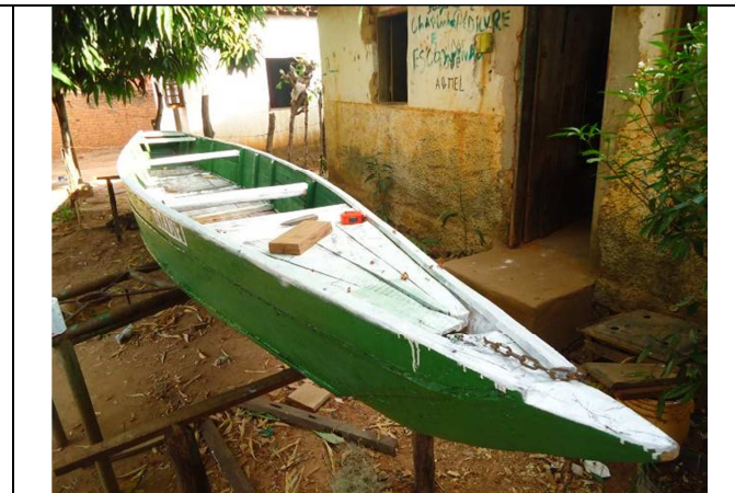
Figura 3: Barco em fase de pintura, com abraçamento em ferro. Fonte: NUHICRE/IEPHA-2013.
