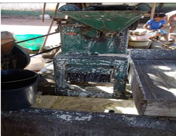
Figura 7: Desintegrador - máquina para ralar a mandioca.
