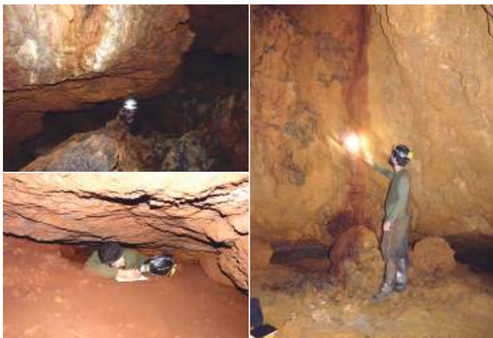
Figura 7 – O trabalho de inventariamento de cavidades envolve a medição dos condutos com trena, observações e anotações detalhadas das características identificadas. (Fotos: Flavio Carmo).
